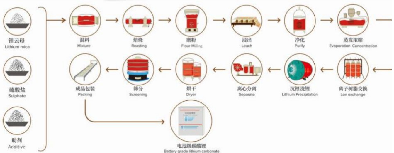
图表 32：公司云母提锂生产流程
