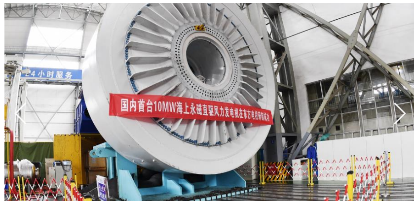
图：亚洲首台10MW海上永磁直驱风力发电机
