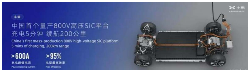
图表17：小鹏汽车量产国内首个 800V 高压 SiC 平台
