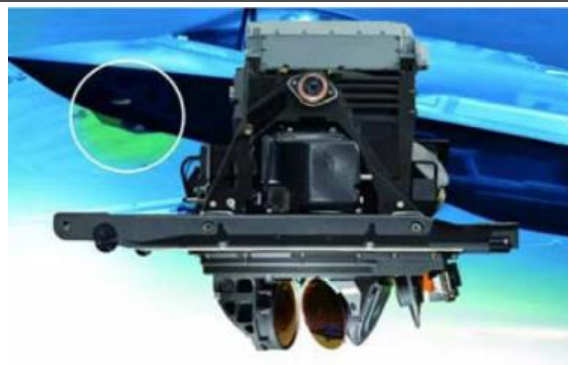
图47：采用铍铝合金制作的美国 F-35 战斗机红外光电瞄准系统万向外壳
