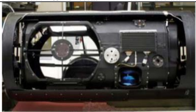
图48：采用铍制光学部件的 F-9120 用航空侦察相机
