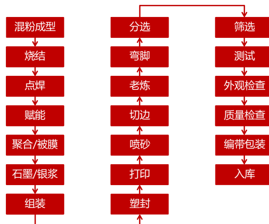
图14：固体电解质钽电容器生产流程
