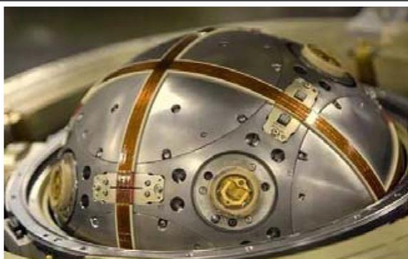
图46：美国和平卫士洲际弹道导弹用的铍材先进惯性参考球
