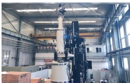
图19：全球首台可控制 24 寸单晶硅棒（刻蚀用）的半导体级单晶炉
