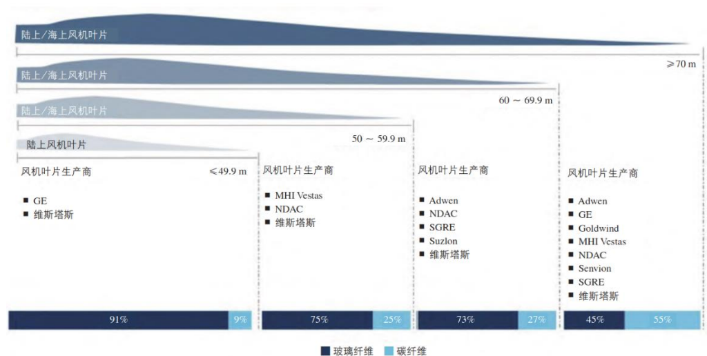
图21：叶片尺寸不断上升预计带动碳纤维主梁叶片占比
