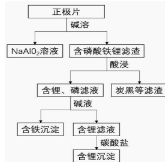
图：湿法回收磷酸铁锂电池工艺流程
