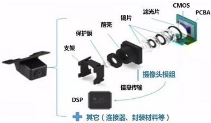
图表 111：车载摄像头组成结构
