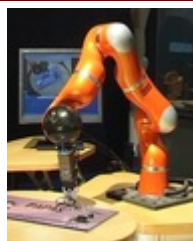
KUKA轻量臂：关节和冗余位置测量都有关节扭矩传感器
