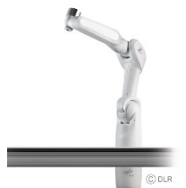
DLR MIRO 医疗机器人：专为外科应用而开发，有效载荷为 3 公斤（重量为 10 公斤）。它集成了 7 个扭矩可控关节和针对标准和内窥镜仪器的手腕设计
