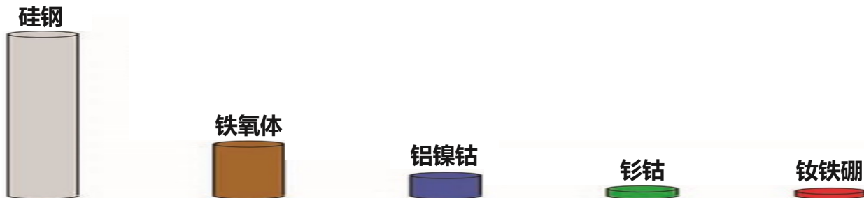
单位磁场强度下，钕铁硼的相对体积最小，利于节省电机空间
