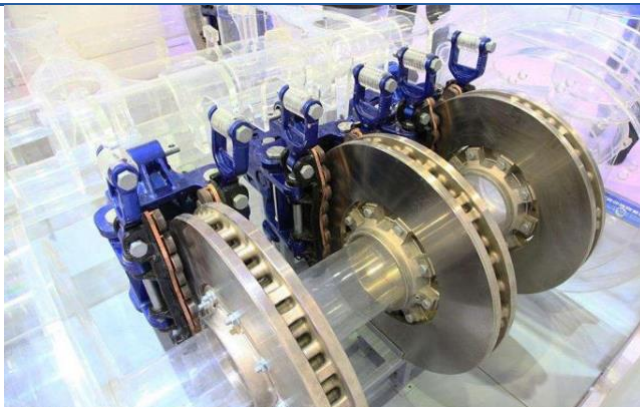
图 27: 闸片与制动盘组成一对摩擦副
