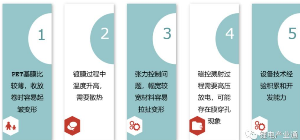
图：磁控溅射环节的工艺难点
