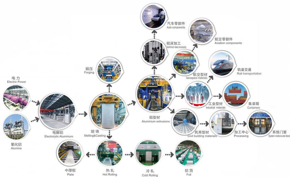
图 8 南山铝业航空板材连轧生产线流程
