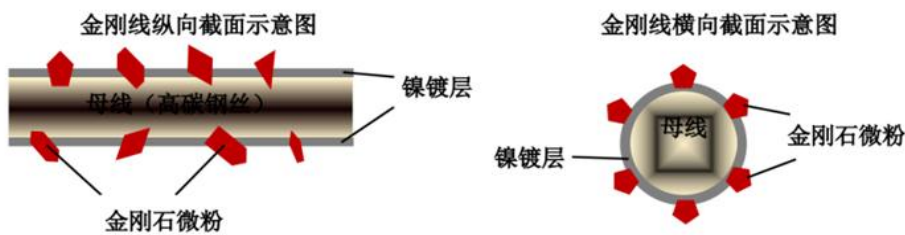
图 26：金刚线的微观结构示意图
