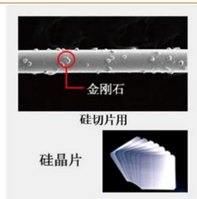
图 28：金刚线结构及应用
