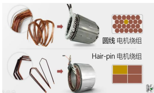
图表 32：扁线绕组可以提升槽满率
