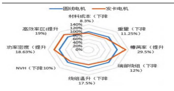
图表 35：圆线电机与扁线电机性能对比图
