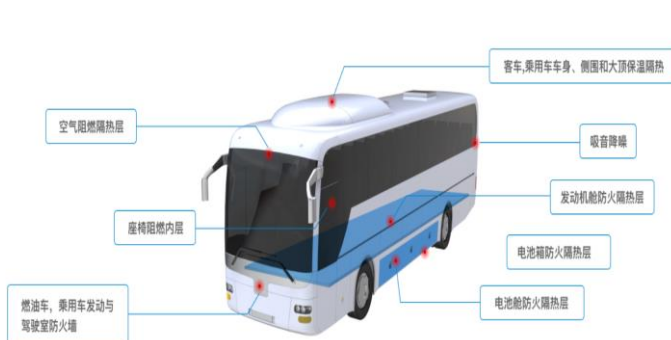
图6：气凝胶制品可用于新能源车整车的防火隔热系统
