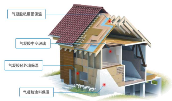
图7：气凝胶制品可用于建筑的节能保温
