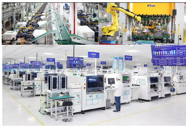
图5：全自动注塑件生产线、金属板自动冲压线与数字化电池工厂
