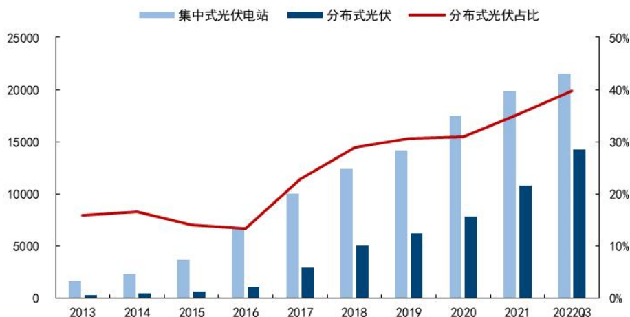
图 15：全国分布式光伏并网装机规模和占比逐年上涨（单位：万千瓦）
