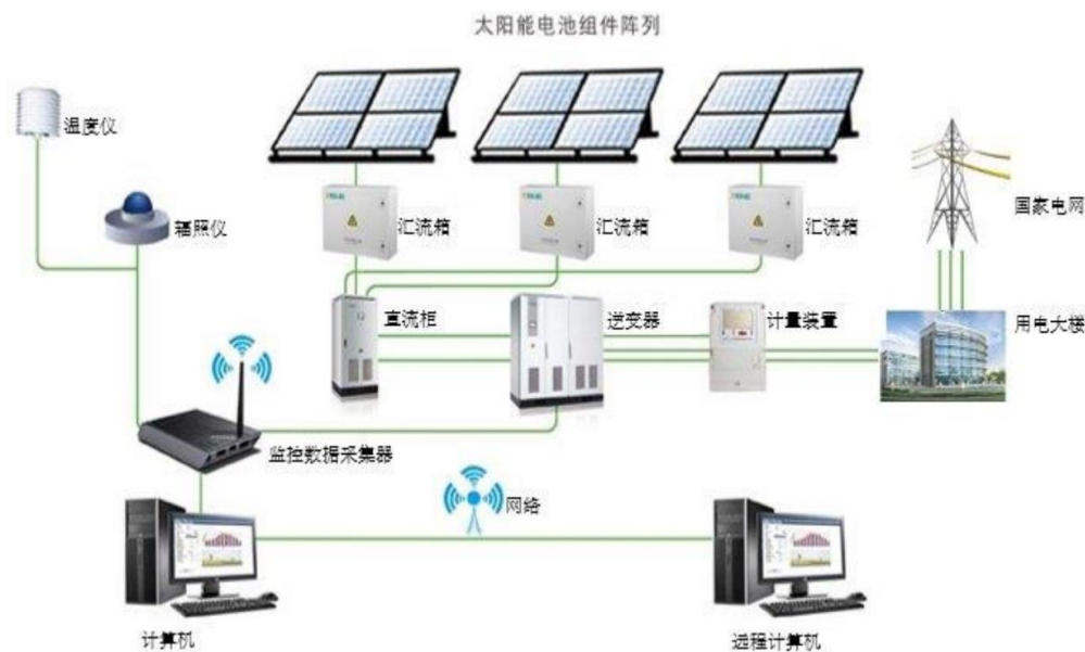
图22：分布式光伏发电特指在用户场地附近建设，用户侧自发自用，多余电量上网
