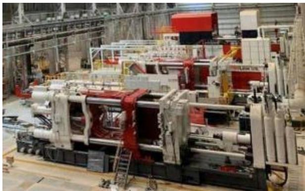
图：特斯拉超级压铸机布局
