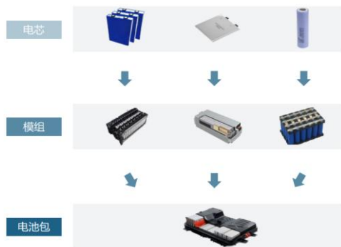
图表16：电池包结构示意图
