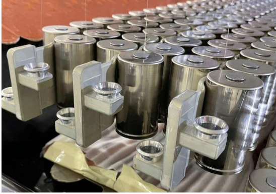
图 19：特斯拉 4680 电池结构拆解图
