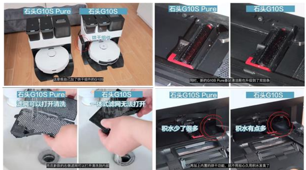
图2: 通过内置烘干、双刮条清洁和可打开滤网优化了 G10S 的基站清洁痛点
