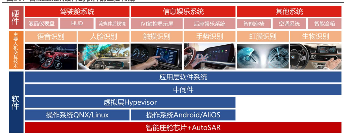
图28：智能座舱从硬件到软件的主要构成
