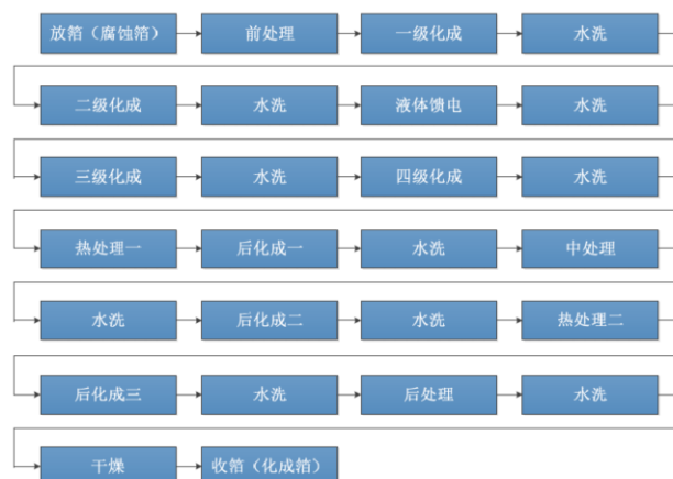
图表23：化成箔的生产工艺流程
