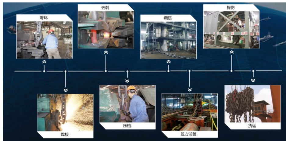
图：系泊链从弯环到货运的流程
