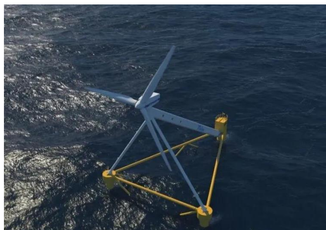
图表25：全球首款无塔筒浮式风机PivotBuoy 技术
