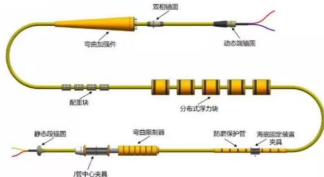
图表19：漂浮式风机需要采用动态海缆
