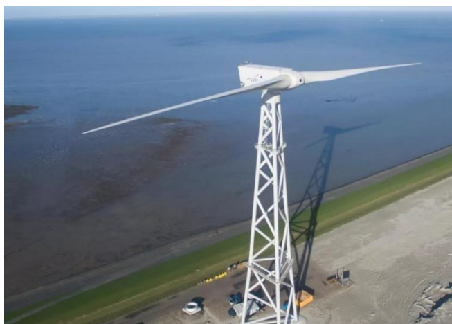
图表24：双叶片风机正在被安装与测试
