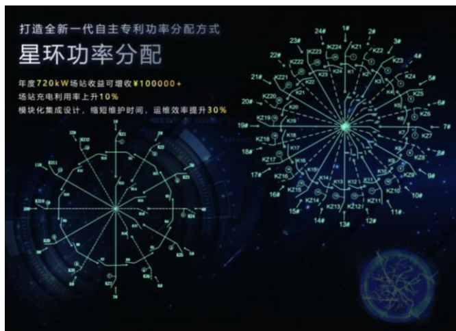
图20：星环功率分配可以节省开关使用数量
