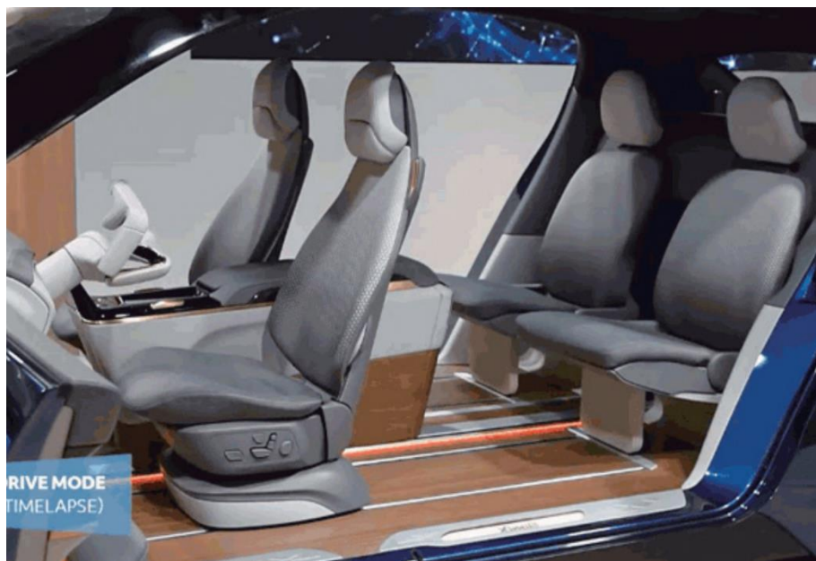
图6：乘用座舱灵活性调整的长滑轨座椅
