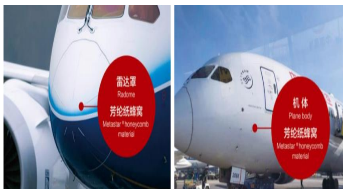
图18：芳纶纸蜂窝应用于雷达罩、机体
