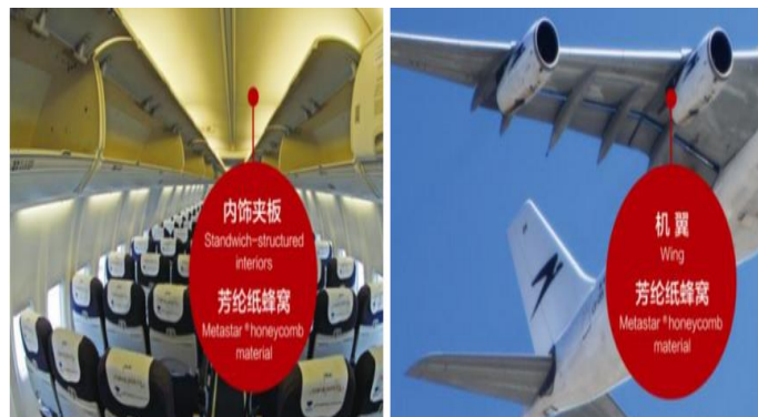
图19：芳纶纸蜂窝应用于内饰夹板、机翼
