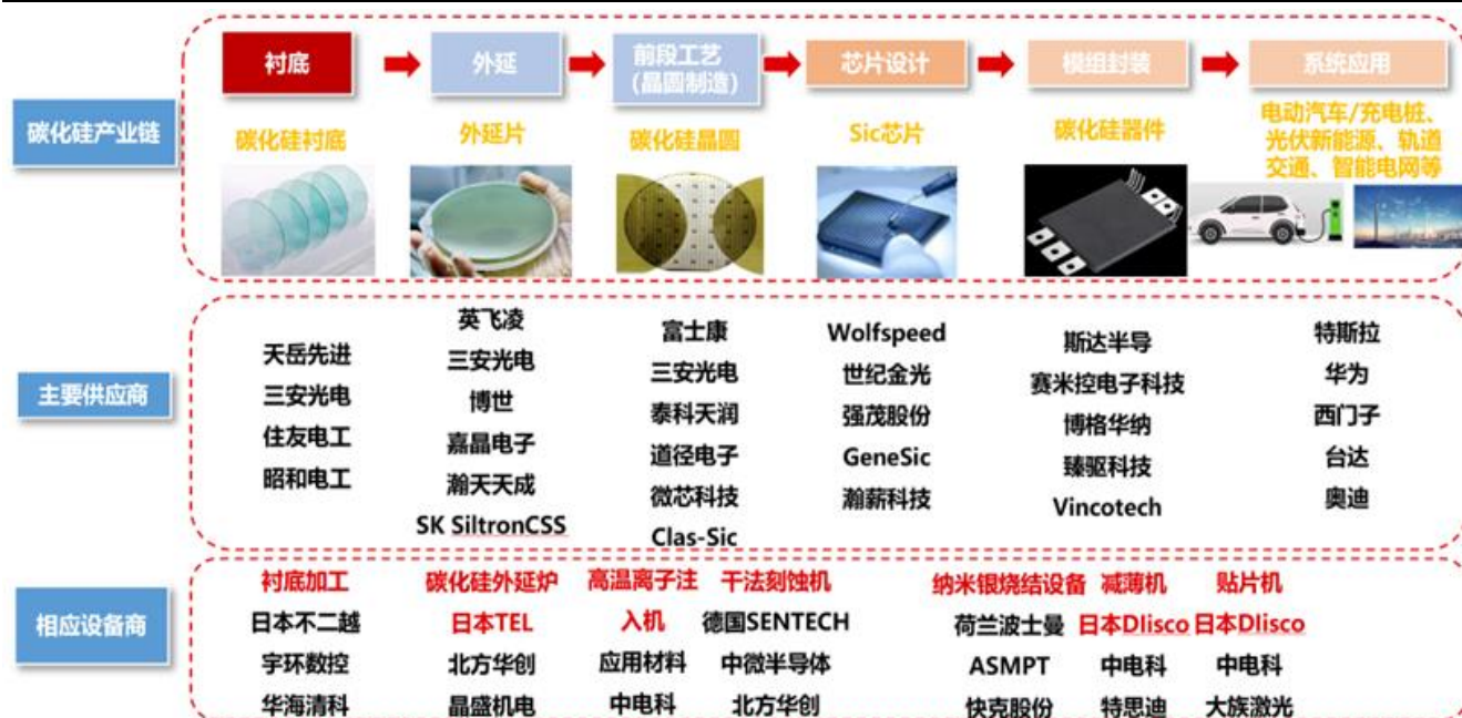
图8：衬底环节是碳化硅器件制造最核心环节，而切磨抛设备是衬底加工最核心的设备
