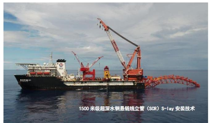
1500 米级超深水钢悬链线立管（SCR）S-lay 安装技术
