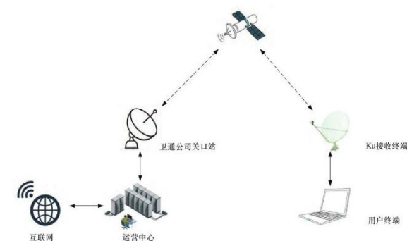
图3: Ka 频段高通量卫星传输系统结构
