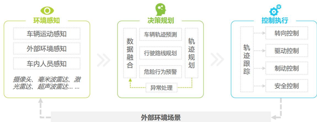
图 43：智能驾驶系统架构
