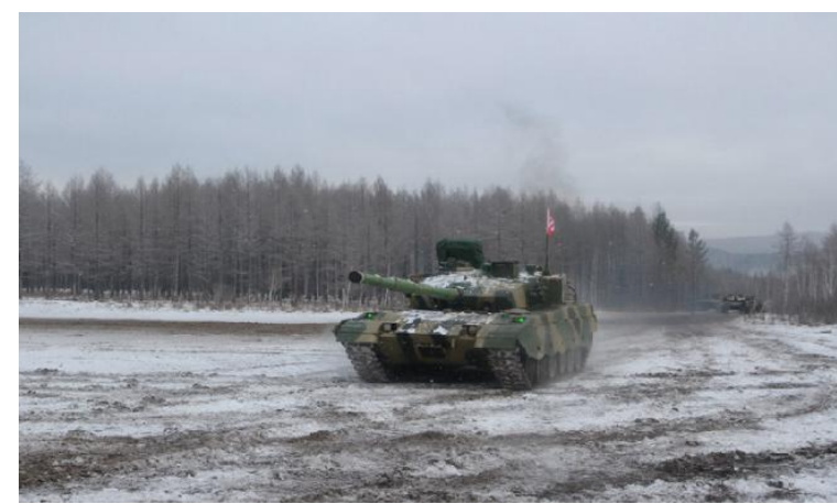
图3：国产某新型坦克在极寒环境下进行可靠性试验
