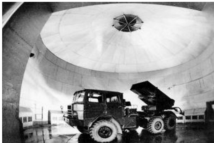
图1：某型自行火箭炮正在进行环境测试
