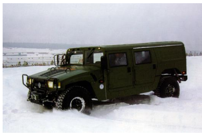
图2：国产东风猛士高机动军用越野车寒区试验
