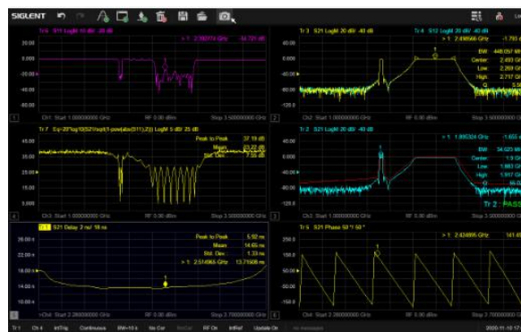
图9：矢量网络分析仪的 S 参数测试功能
