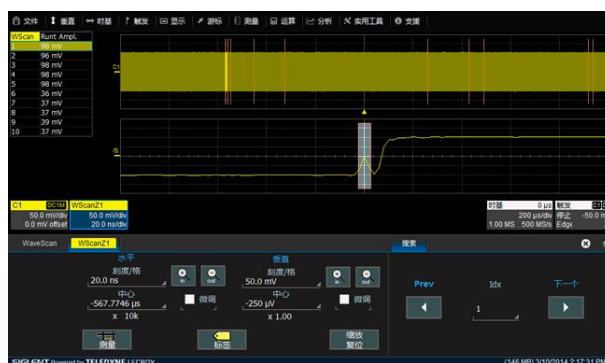
图3：数字示波器的高级波形搜索和分析功能 WaveScan
