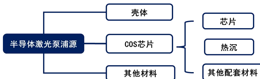
图 16：半导体激光泵浦源结构
