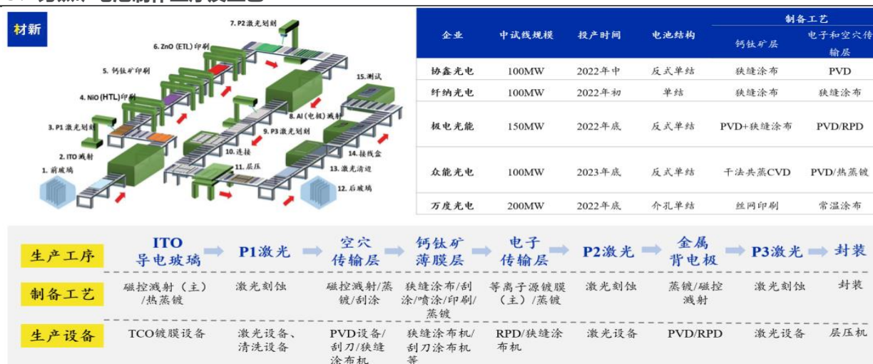
图13：钙钛矿电池制作工序及工艺
