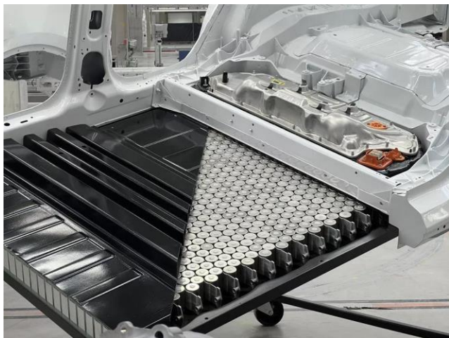
图表3 柏林工厂 4680 电芯直接集成于汽车底盘
