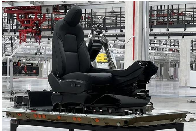
图表4 前排座椅直接置于电池包上
