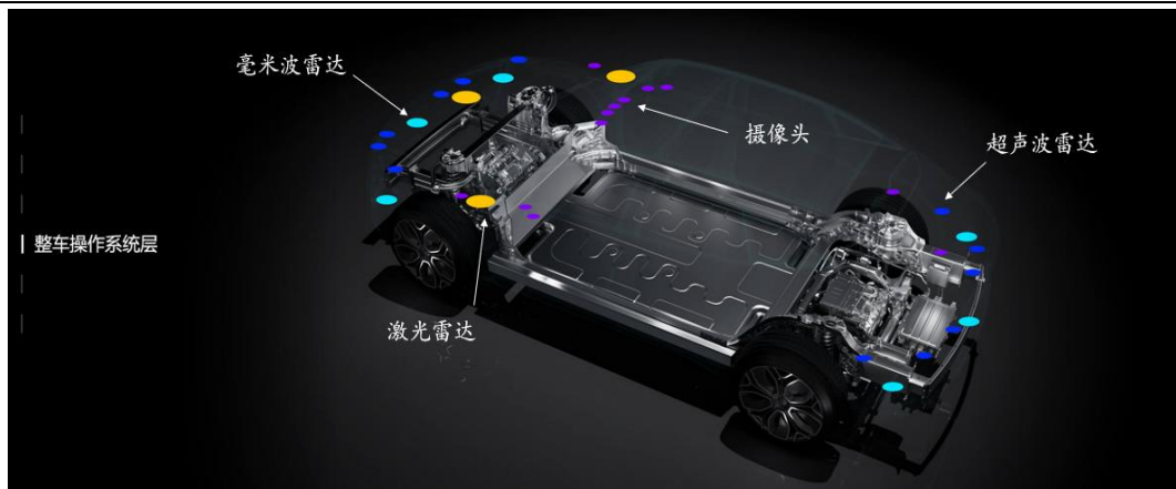
图表73.阿维塔 11 传感器配置
