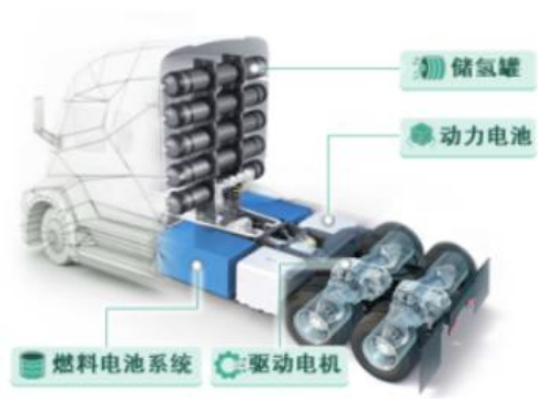
图 16：氢燃料电池重卡的系统示意图
