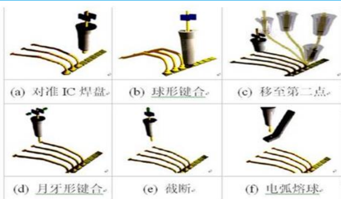
图表70：陶瓷劈刀在引线键合过程中的应用
