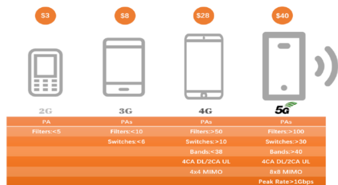
图表36：5G 手机射频模块器件变化
