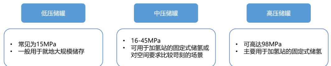
图表43：储氢容易分为低压、中压、高压三类，中高压可用于加氢站
