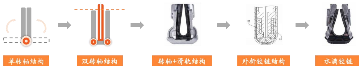
图表19 折叠屏铰链结构的发展历程
