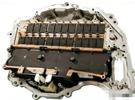
图 4：特斯拉 Model 3 逆变器搭载 SiC MOSFET 模块
