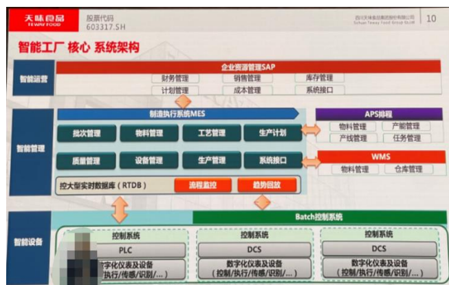
图 26 天味智能工厂的核心和系统架构
