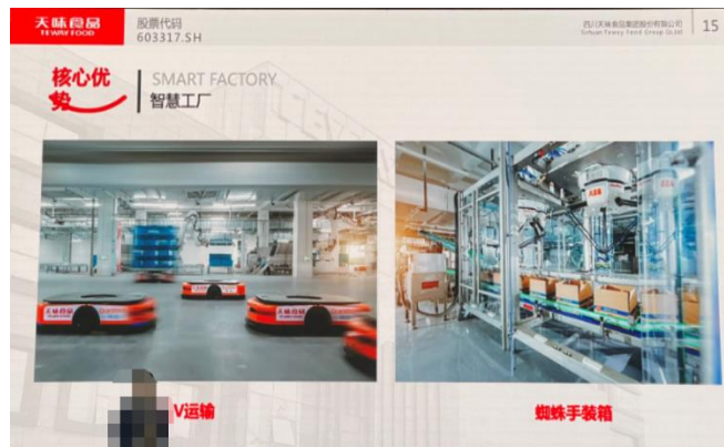
图 28 天味智慧工厂的 AGV 运输和蜘蛛手装箱
