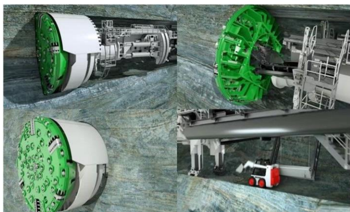
图表16: 盾构机工作示意图
