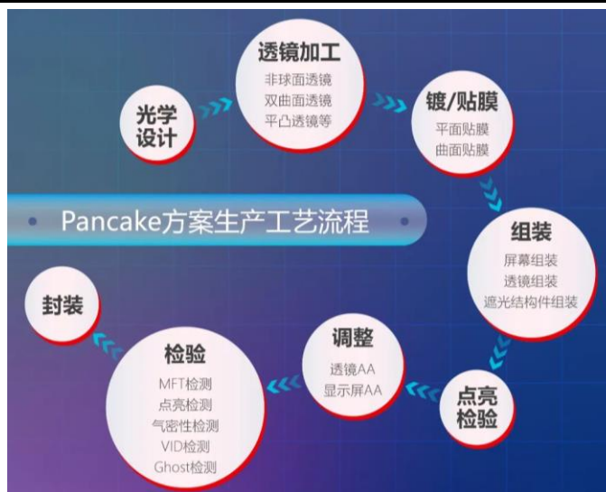
图14：斯迪克 Pancake 方案生产工艺流程
