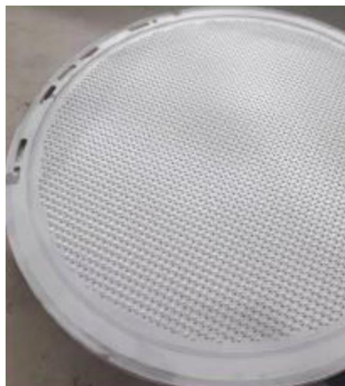
碱性电解槽极板图片及示意图
