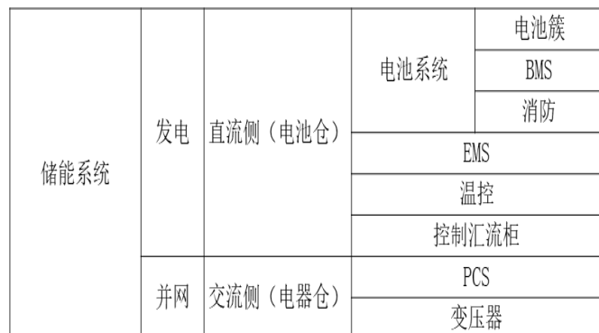
图 11：储能系统分为直流侧发电和交流测并网
