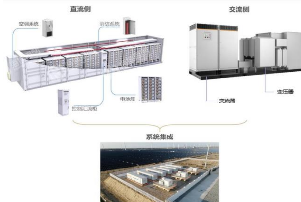
图 12：电化学储能电站系统构成图
