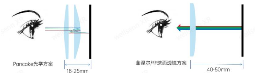
图4: Pancake 光学方案 TTL（光学总长）低于传统光学方案
